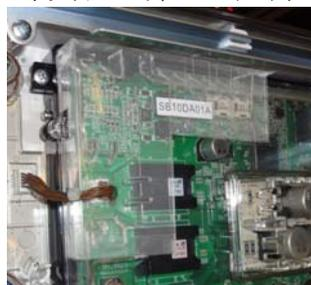
**対策効果** サブ基板左側からの接触経路を防御します。
