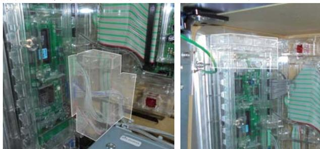
**特長** サブ基板上部・主基板下部等への異物の挿入を防止します。
