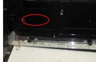
ビス穴を塞ぎ、穴開けによる改造行為を防止します。
