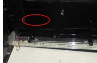
ビス穴を塞ぎ、穴開けによる改造行為を防止します。
