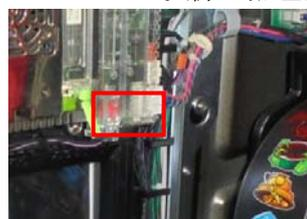
**特 長** 無理に外すと成型品が壊れるか封印シールが大きく損傷します。
